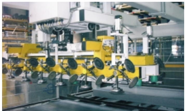
automatische Breiten- / Längenverstellung der Saugtraverse
