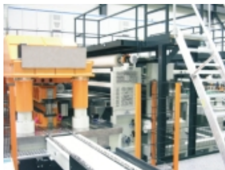
Querteilanlage mit Foliermaschine
